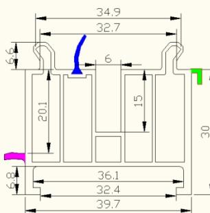
Montážní a přepravní profil Metal-Plast je určen pro správné provedení montáže a izolace okna a upevnění parapetů.
